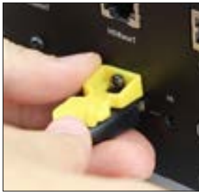
2 将LockPro™放置在松动的螺丝上
