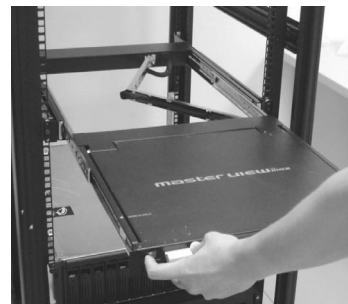
步骤 3. 拉出 LCD KVM 多计算机切换器 / LCD 控制端滑入，即可开始工作
