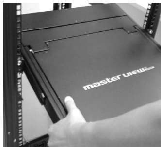
步骤 2. 将 LCD KVM 多计算机切换器 / LCD 控制端滑入滑轨中，并固定于机架上
