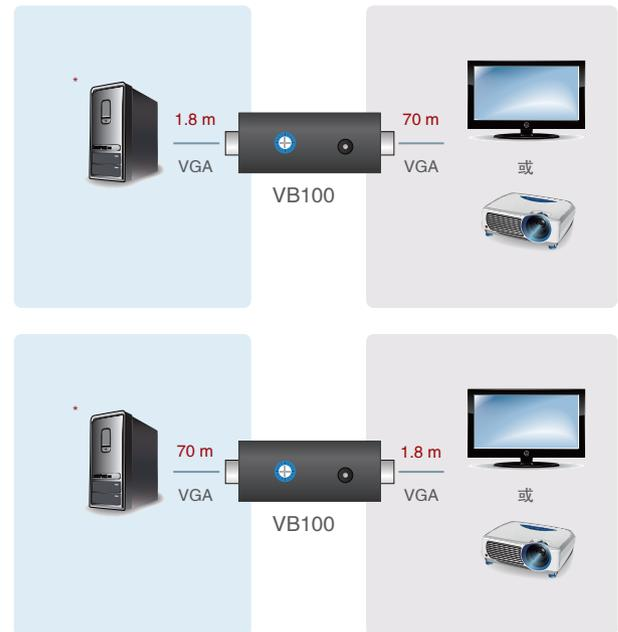
\* 如果来源端设备无法启动VB100，请使用包装内所附的电源适配器。
